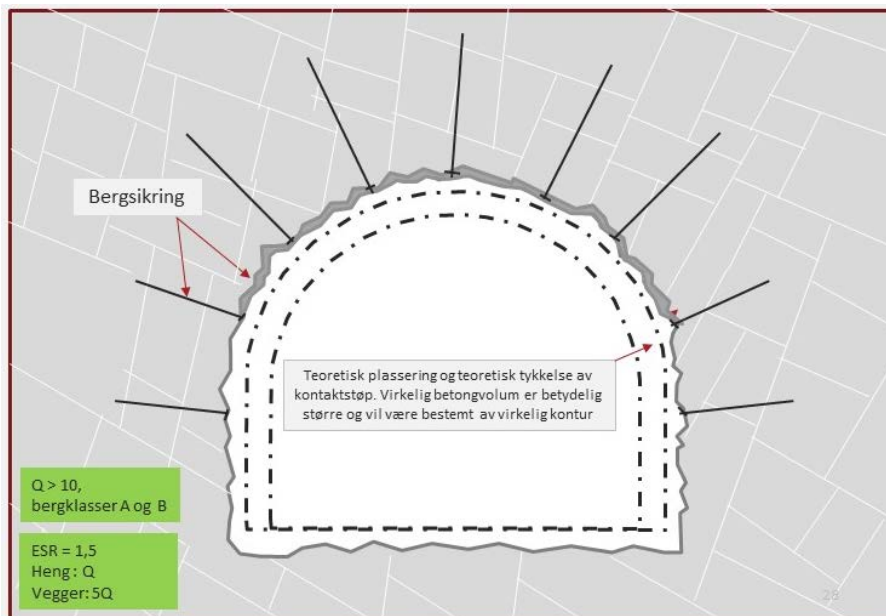
Figur 10 Prinsippkisse med anbefaling for bergsikring utført på stoff for bergklasser A og B. Sprøytebetongtykkelsen er minimum 6 cm og fastsettes, sammen med bolteavstand og boltelengder i henhold til sikringskategoriene i figurene 8 og 9.
