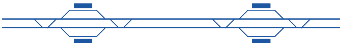
Figur 3.6: Dobbelspor på høyhastighetsbane med gjennomgående spor på stasjonene, uten plattform, for ikke-stoppende tog.
